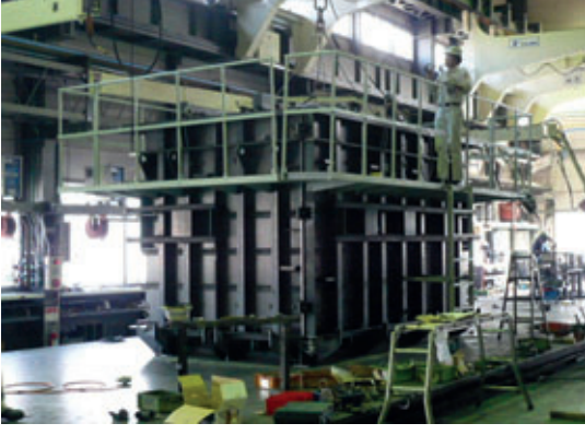
Şek. 5 ve 6: Bir prekast parça kalıbı ve grafik sunumu
